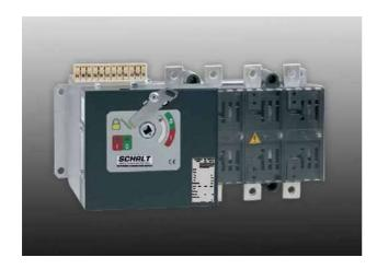
Dalla stessa linea dei sezionatori serie HLNS, nasce la serie dei sezionatori motorizzati HLNSM, dotati di motore elettrico per comando di apertura e chiusura a distanza. L'alimentazione ausiliaria del motore è multitensione a 12/24V DC, 110/220/380V AC, mentre i comandi di apertura e chiusura vengono gestiti tramite contatti a potenziale libero.
