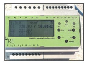
Se non vengono rilevati errori, il relè si porta automaticamente alla pagina 1.010 (vedi sul display in alto a sx) e parte il conto alla rovescia per la connessione (vedi display in alto a dx).
