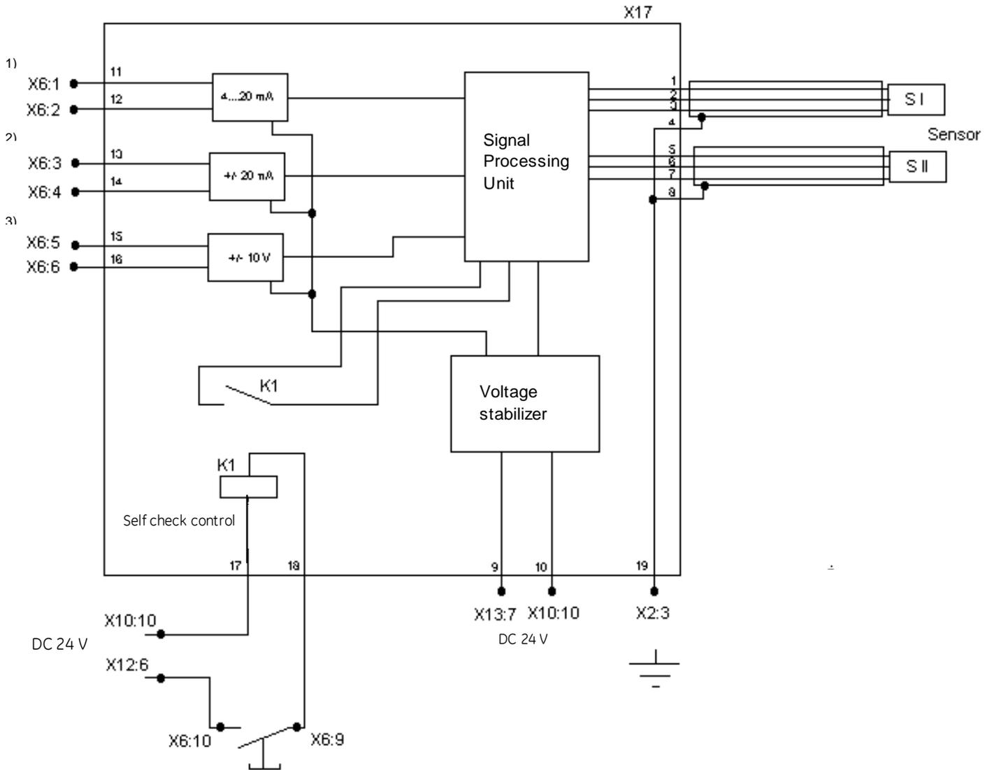
1) max. 500  $\Omega$     2) max. 500  $\Omega$     3) min. 300 k $\Omega$
