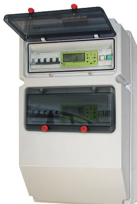
I Quadri **CEI 0-21** sono già predisposti secondo le taglie di potenza tipiche delle combinazioni di inverter presenti sul mercato, da **20kW fino a 125kW**, e sono completi di interruttore generale con bobina di rincalzo, contattore DDI in AC-3, relè di interfaccia NA003 con soccorritore, eventuali interruttori di protezione inverter con differenziale in classe A 300mA.
