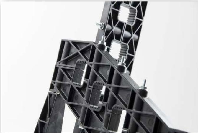
Portabarre in poliammide inclinati o lineari realizzati per supportare profili C-Link fino a 1600A. Gli isolatori sono progettati per occupare il minor spazio possibile, possono essere posizionati dietro o a lato del pannello o nel sottotetto se è necessaria una divisione su tutta la lunghezza del quadro. Il sistema inclinato consente la massima accessibilità al collegamento semplificando il cablaggio.
