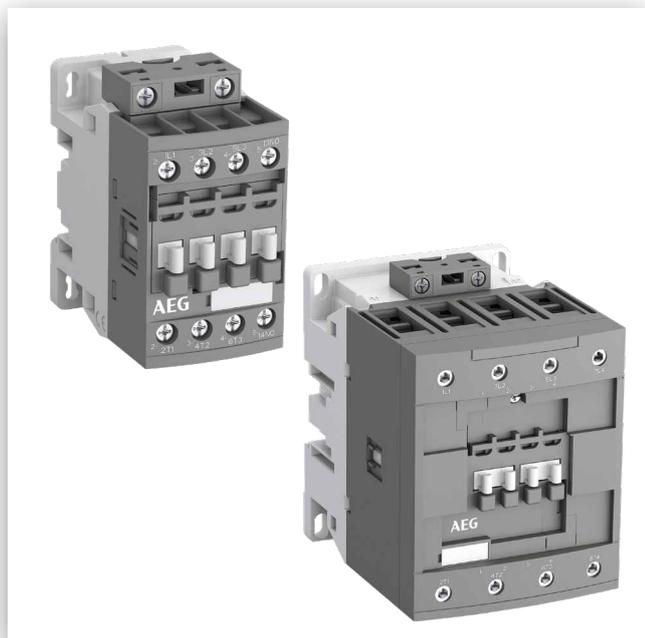
Nuova linea di contattori di potenza AEG per avviamento di motori e comando di carichi a 3 e 4 poli fino a 45kW / 96A in categoria AC-3 a 400V.
