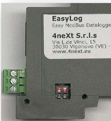
Fig. 6 Posizione DIP per DHCP.
