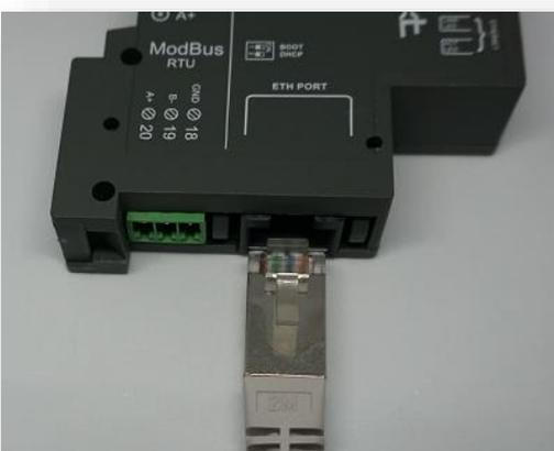
Fig. 3 Connettore Ethernet
