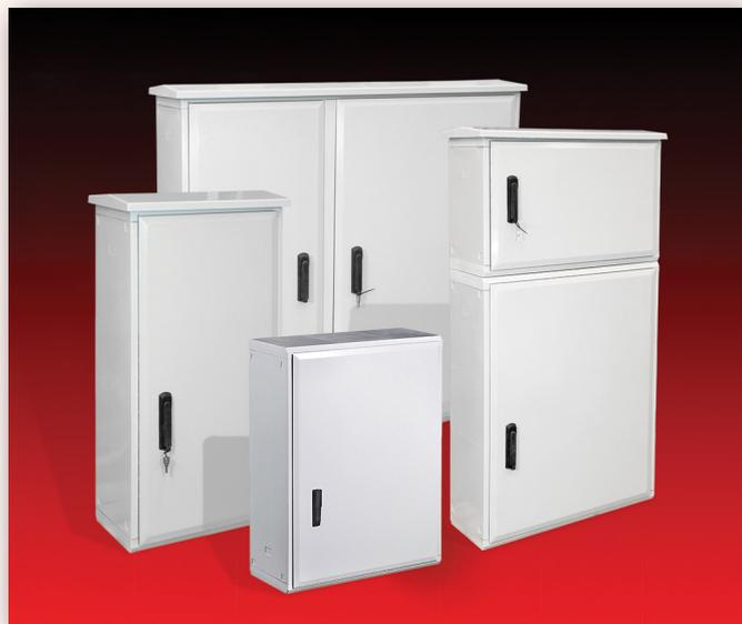
Armadi in poliestere rinforzato per applicazioni in esterno, tipicamente come armadi stradali, per posa a pavimento con zoccolo, oppure a parete. La serie GL viene proposta in due versioni, con involucro completamente chiuso per applicazioni universali in esterno o in interno, e nella versione per uso stradale, con fondo aperto e tetto parapioggia, sempre con grado di protezione IP55.
