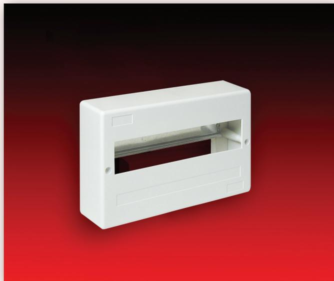
La serie Pegasus di calotte per la distribuzione di energia, sono una soluzione pratica e compatta per la realizzazione di quadri elettrici per uso domestico, fino a 63A, in combinazioni da 2 a 18 moduli, in un'unica fila. Sono costruite in materiali termoplastico autoestinguente, con prova Glow-Wire fino a 650°C per 30sec, nel colore bianco RAL 9016.
