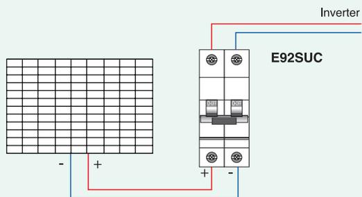
**Fotovoltaico - Sistema isolato Ue=1000V**
