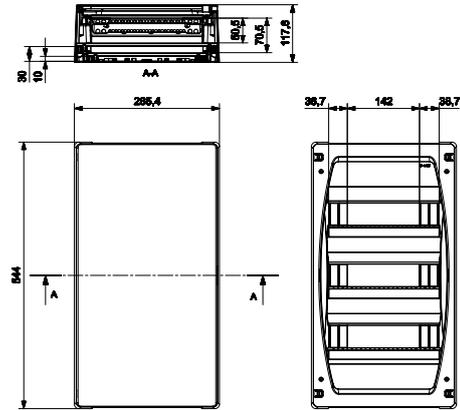
**Dimensioni - Serie SGS ad INCASSO con montaggio a MURO**
